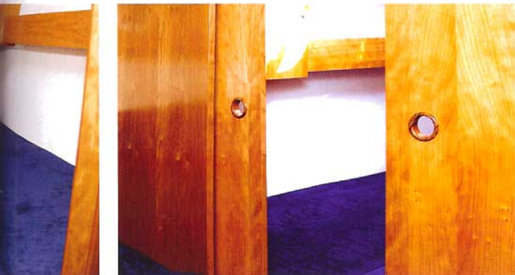
Et par skydedøre i tyndt finer, skal sikre privatlivet i forkahytten.
